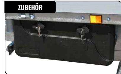
**Robuster Werkzeugkasten** mit integriertem Schloß für die Aufbewahrung von z.B. Verzurrgurten etc.
